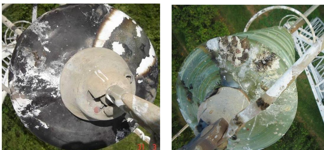
**Figura 17 - Cadeia de isoladores contaminados com excrementos de curicacas**
