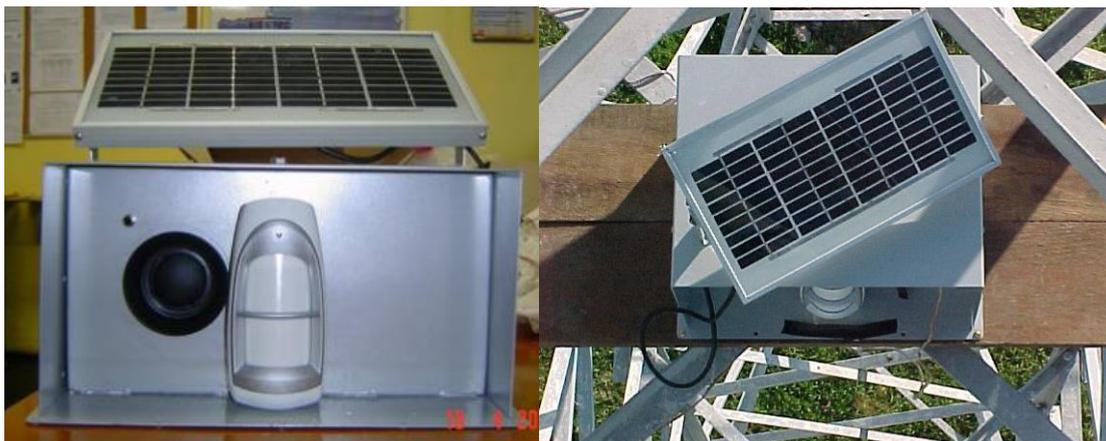
Figura 21 – Espanta Pássaro Sonoro - Sistema Digital Microcontrolado – Produto P & D
